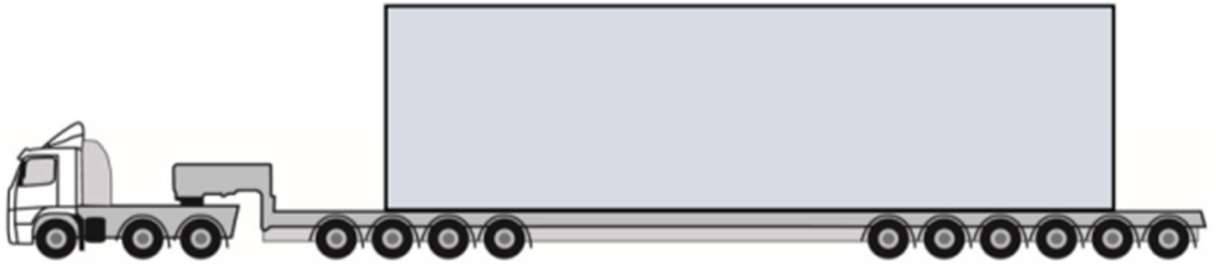
Kuva 169. Esimerkkikuva lastatusta tornilohkon erikoiskuljetuksesta
