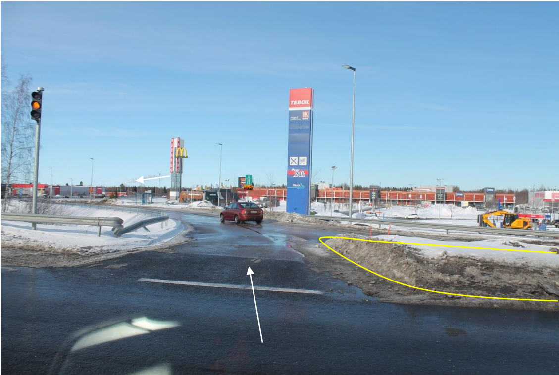
Sijainti 21/Kuva 47. Tien 4 ramppi: Kaakkuri. Korkeat lastit kuljetetaan liittymäramppien kautta. Merkitty alue liikenteenkakajasta tulee poistaa.
