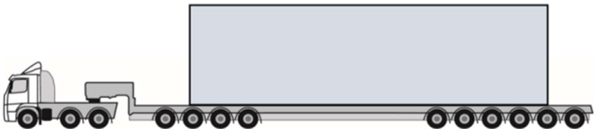
Kuva 2: Esimerkkikuva lastatusta tornilohkon erikoiskuljetuksesta
