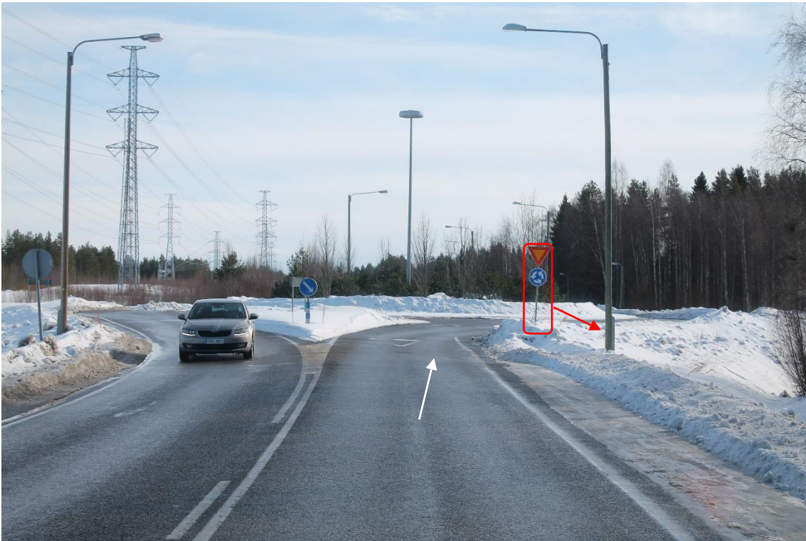
Sijainti 28/Kuva 63. Tien 8300 liikenneympyrä. Reitti 1. https://goo.gl/maps/xdV2q1A5ViB1Vt976 Merkitty liikennemerkki poistettava tai siirrettävä lyhtypylvään viereen.
