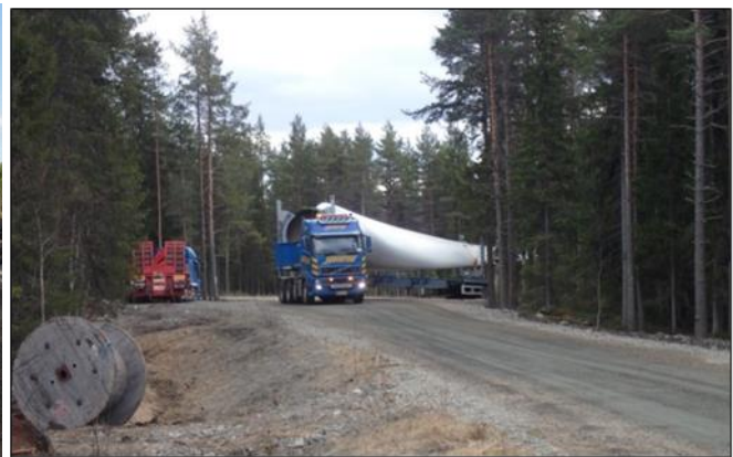
Kuva 72. Vasemmallä kuvassa on esimerkki tuulivoimapuiston rakennus- ja huoltotiestä. Teitä käytetään muun muassa betonin, soran ja voimaloiden komponenttien kuljetuksiin sekä tuulivoimapuiston käyttövaiheessa huoltoajoihin. Maakaapeli sijoitetaan ojakaivantoon tien reuna-alueelle. Oikealla kuvassa tuulivoimalan osia kuljetetaan erikoiskuljetuksina. (Kuvat: Ville Suorsa / FCG).
