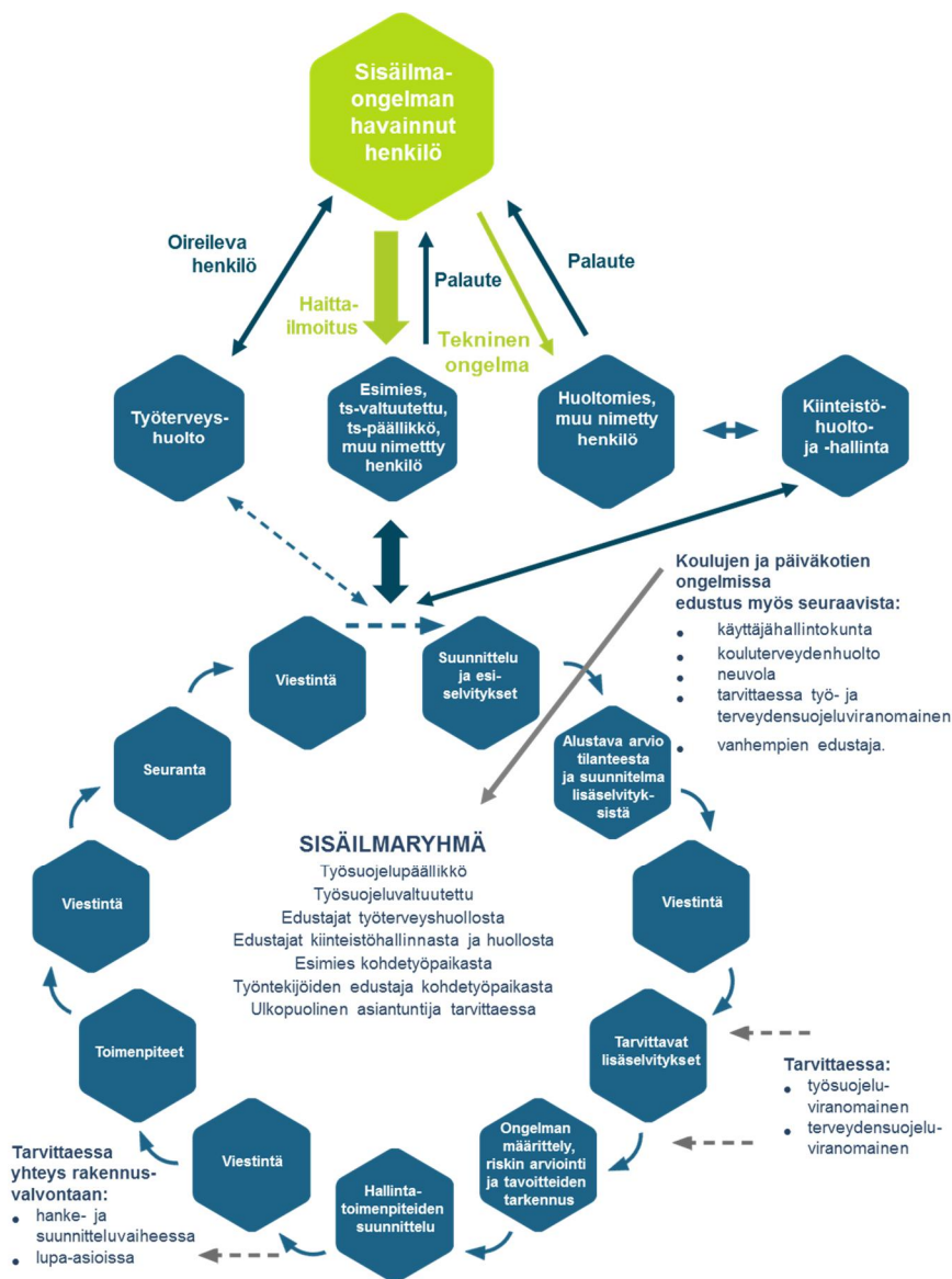
Kuva 1. Toimintamalli sisäilmasto-ongelmien ratkaisemiseen eri toimijoiden yhteistyönä.
